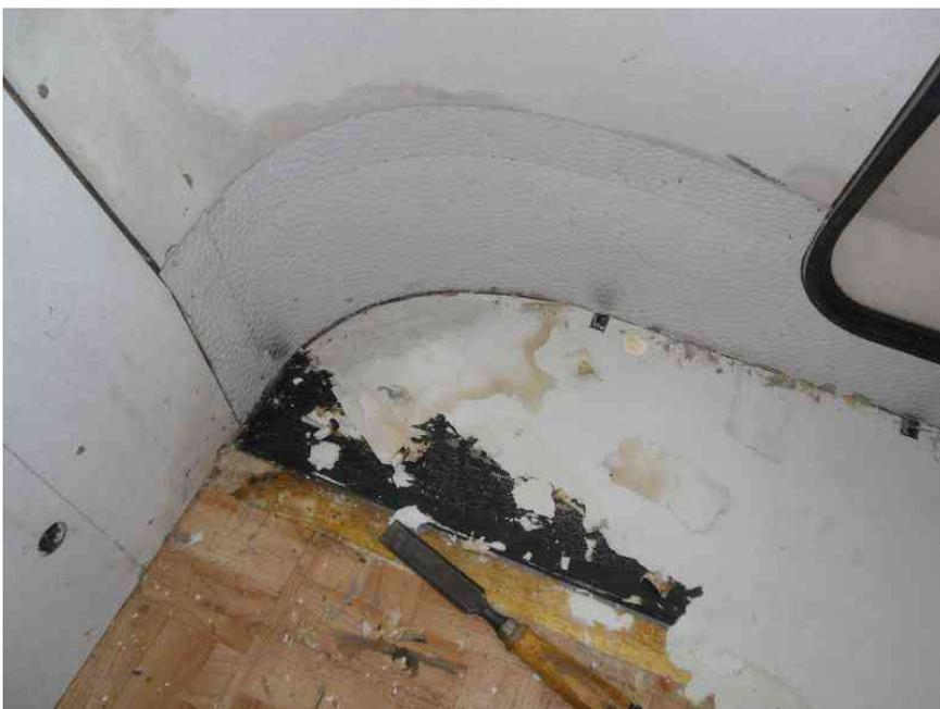
Entfernen des PVC Belages im Gaskasten mit der angeklebten Unterseite
