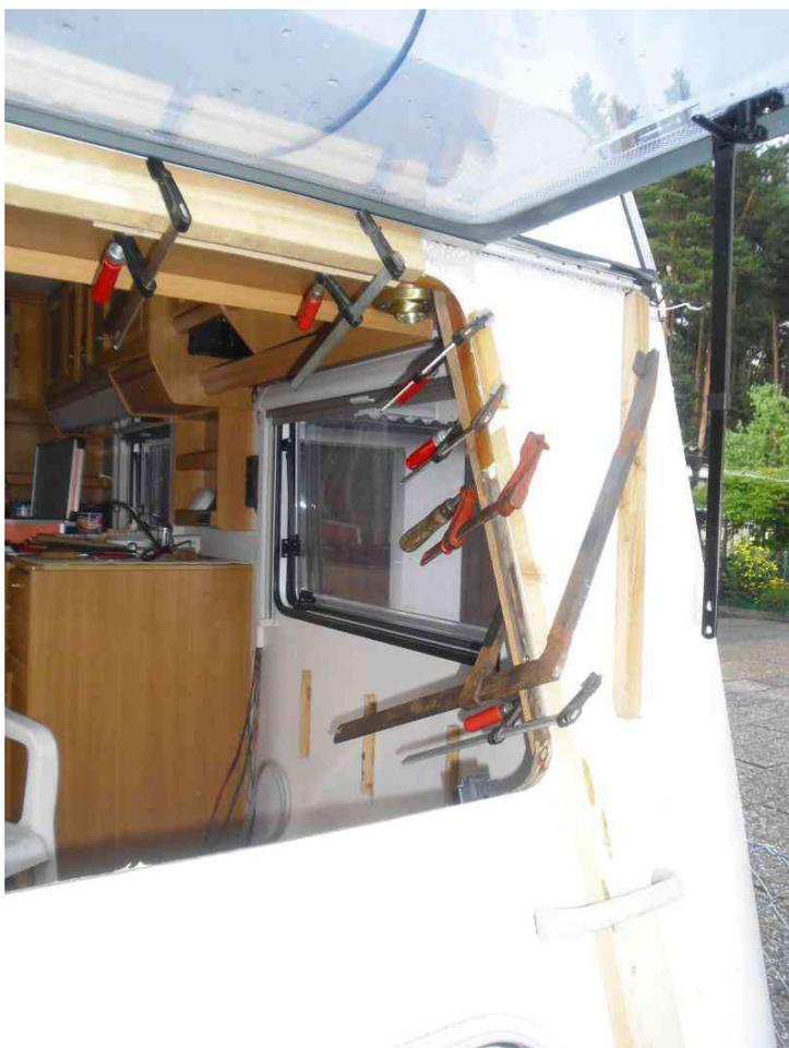
Auf der rechten Seite presse ich nur durch kurze Latten, die mit einer Schraube an festem Holz fixiert werden. Das hält auch gut, da hier kein großer Druck nötig ist. Wenn dann alles voll mit Schraubzwingen ist, sollte man die weiteren Arbeiten einstellen. Man kann sich damit ganz gehörig verletzen, deshalb lasse ich Geklebtes immer über Nacht austrocknen.
