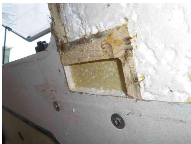
Ausschnitt für Verschraubung der Rolloschiene
